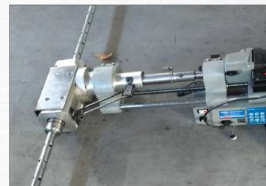
APARATO DE TRANSMISIÓN DE GIRO AVANCE PERPENDICULAR - ACCESORIO Y COMPLEMENTO PARA LA MANDRINADORA PORTÁTIL
