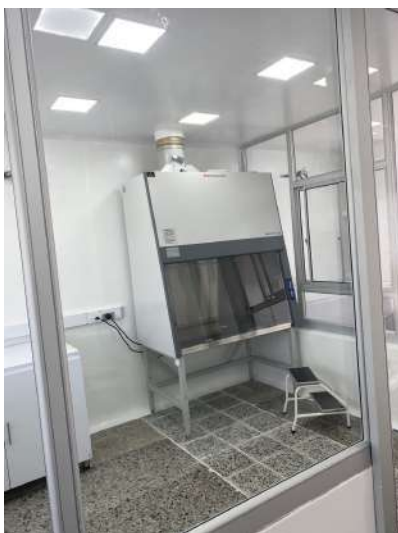
Cabina de bioseguridad clase II B2 instalada
