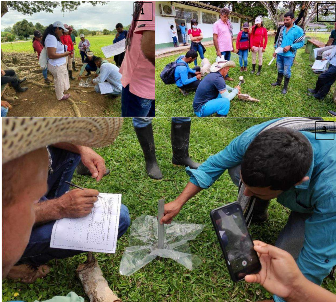
Figura 18. Practica de infiltración. 1) Suelo arenoso. 2) suelo con cobertura de pasto. 3) registro de lámina de agua y velocidad de infiltración.
