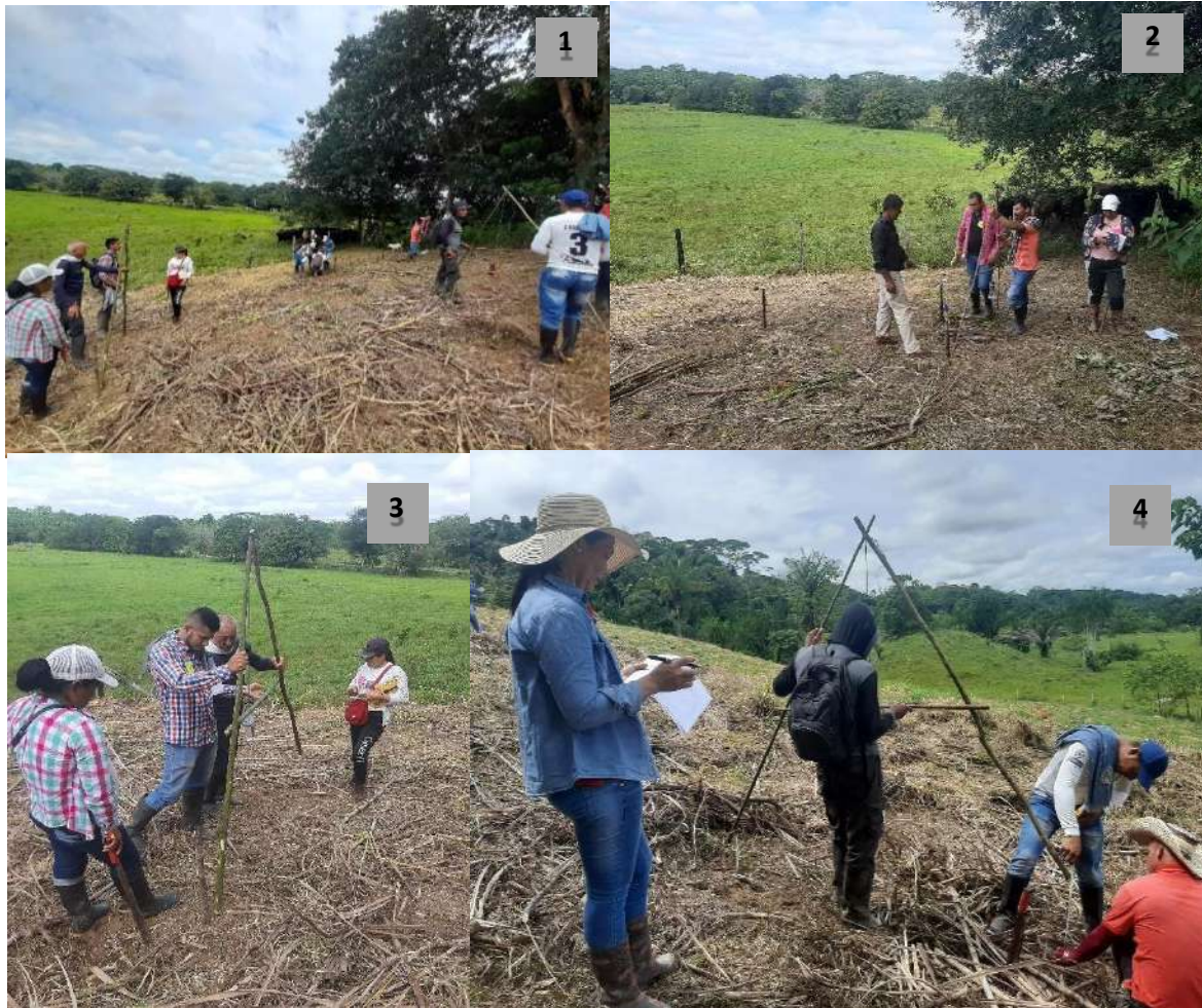
Figura 5. Calibración y toma de % pendiente. 1) Instrucciones para calibración y % pendiente con el aparato “A” 2) Calibración del agronivel. 3y 4) Metodología para determinar el porcentaje de pendiente
