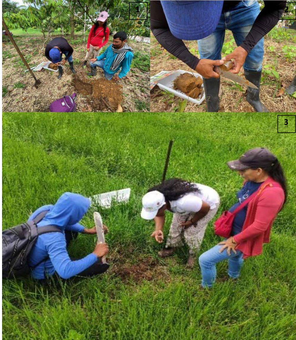
Figura 19. Practica de toma de muestra de densidad aparente. 1) mini calicata. 2 y 3) cilindro de densidad aparente retirando el exceso de suelo.
