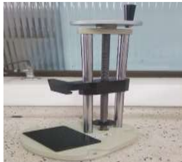
Ilustración 19. Soporte para el penetrometro -Puesto de prueba LTS20
