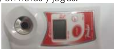
Ilustración 21. Refractómetro digital, Brix 45-93%, resistente al agua.
