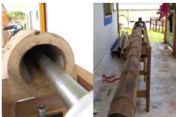
Ilustración 12. Estudio de la guadua como tubería para el diseño y construcción de drenaje agrícola en la USCO – Pitalito
