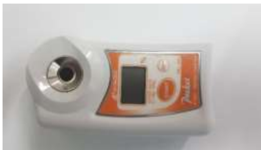
Ilustración 20. Refractómetro digital para Ácido cítrico, resistente al agua. rango 0 - 10%, de ácido cítrico
