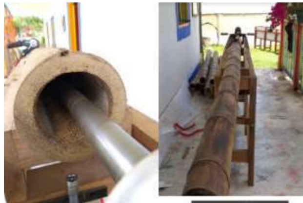
Ilustración 19. Estudio de la guadua como tubería para el diseño y construcción de drenaje agrícola en la USCO - Pitalito
